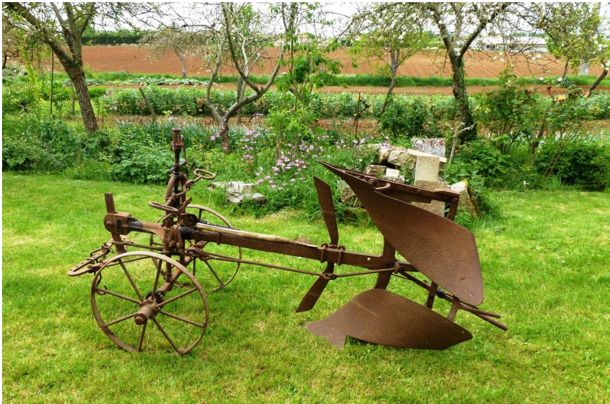
Le brabant UAB n°4, à avant-train, avec double jeu de socs. Avec un poids supérieur à 200 kg, il permet le labour en profondeur. Fabriqué par VIAUD à BARBEZIEUX.
