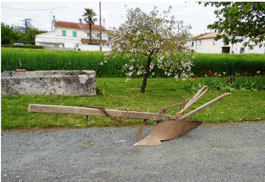
Première charrue Dombasle en fer Le versoir est en fer et l'armature encore en bois.
